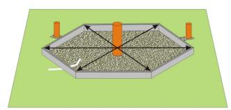
Setzen Sie nun 20er-Rasenkantensteine in Beton ein so dass diese ca.10cm aus dem Boden ragen.
