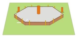
Befüllen Sie die Schalung bis zum Rand mit Beton. Verdichten Sie den Beton und Glätten Sie die Fläche.
