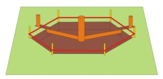
Verlegen Sie, wie auf der ersten Seite im Fundamentplan angegeben, die KG-Rohre.
