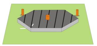
Beschichten Sie das Fundament mit Teerbahnen oder legen Sie bei der Montage eine PE Baufolie unter.
