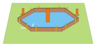
Legen Sie nun auf die Kiesschicht eine PE Baufolie aus, um ein späteres Eindringen von Feuchtigkeit in die Betonplatte zu vermeiden.
