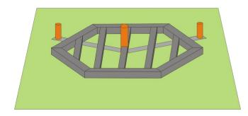
Setzen Sie Kellerwandsteine in den feuchten Beton so dass diese ca.10cm über das Erdreich hinausragen und eine ebene Fläche bilden.
