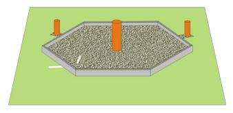
Füllen Sie die Fläche so mit Füllkies auf, dass nach dem Verdichten noch 5cm bis zur Oberkante der Rasenkantensteine verbleiben. Ziehen Sie die Fläche plan ab.
