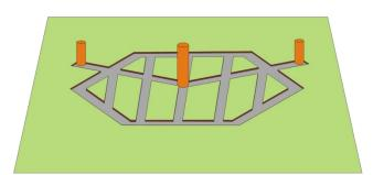
Verfüllen Sie die Ausschachtung bis ca. 5cm unter Bodennivau mit erdfeuchtem Beton (C25/30). Legen Sie in verschiedenen höhen 10mm Armierungseisenein.
